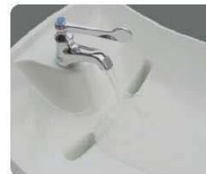
●配管詰りのトラブルを無くすため内部排水管を用いず、シンク上部のスリットから脚部の両側面を溝のように水が流れていくシステムとしています。ゴミの堆積やいたずら等による配管詰まりで水が滞る不衛生な状態になりにくく、利用者が快適に使えるようにしています。
