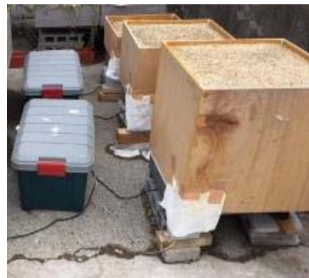
写真 4-1 土壌の乾湿を含めた重量試験設置例
