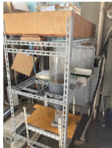
写真 2-2 簡易降雨機を用いた試験状況
