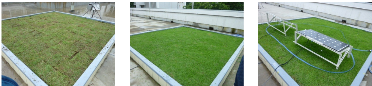
写真 2 屋上緑化試験区。左から、ソッドを敷いた直後(2012 年 5 月 2 日)、芝生養生中(7 月 20 日)、太陽電池設置日(8 月 4 日)に撮影した写真である。
