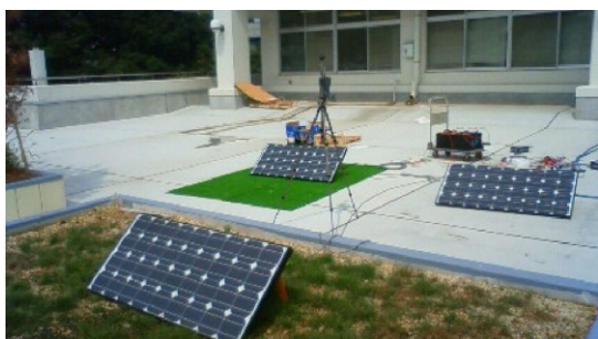
写真 1 実験風景。太陽電池の位置は手前からケントッキーブルーグラスを播種した天然芝生区、左奥が人工芝生区、右奥がコンクリート区。
