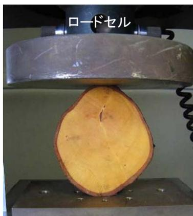
写真4 ソメイヨシノの根の断面の圧縮試験状況(1mm/分、20°C)
