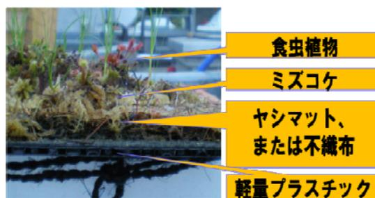
図-1 浮島の構造
