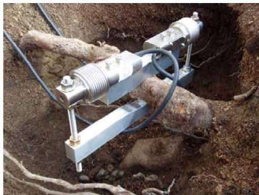
写真5 肥大力測定装置の設置状況
