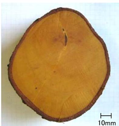
写真3 力学的性質測定に用いたソメイヨシノの根の断面
