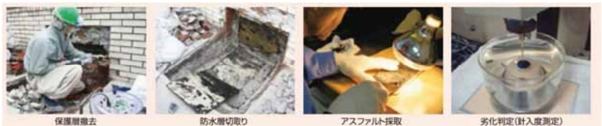
写真-5 経年防水層試験のプロセス
