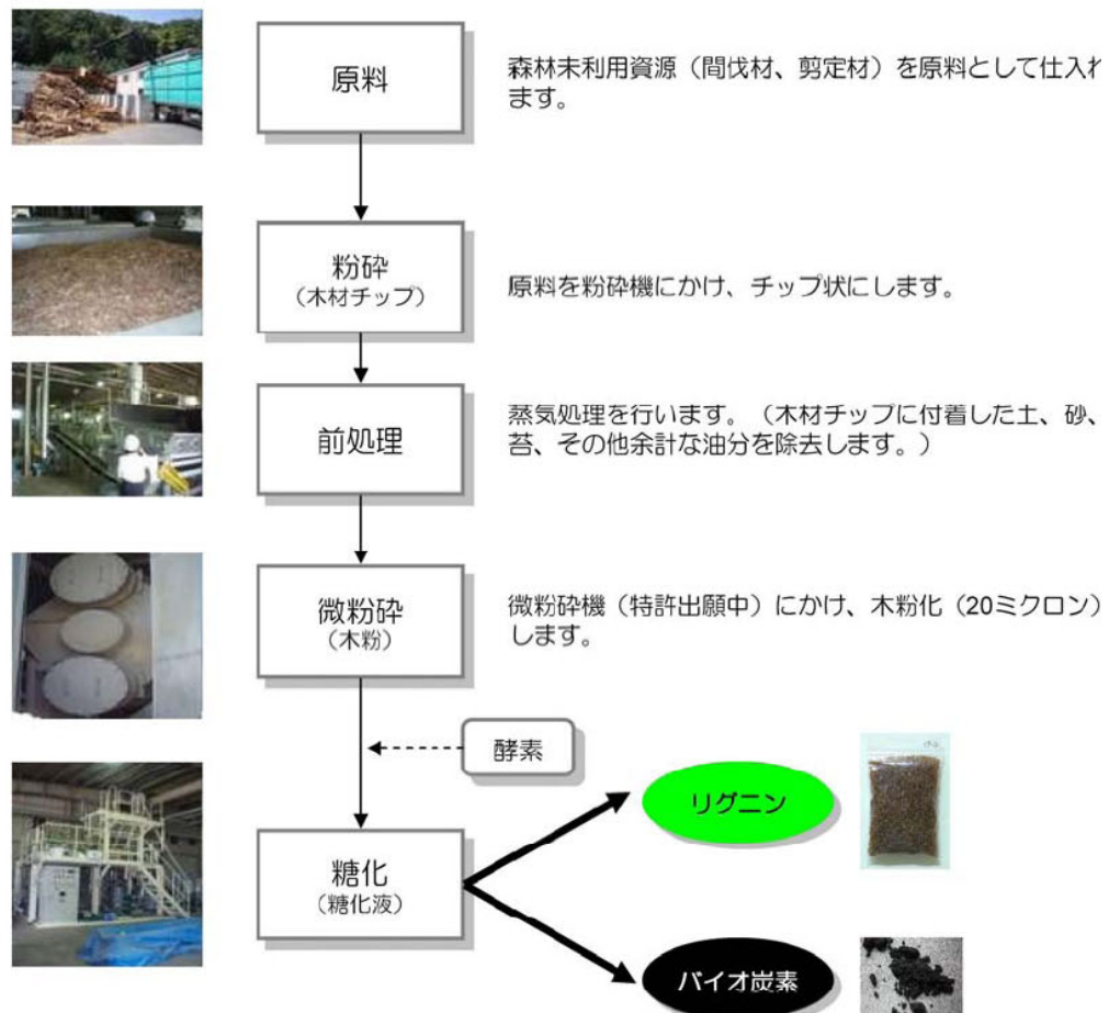
図-2 リグニンおよびバイオ炭素の製造フロー
